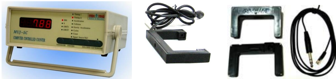
圖 2 永原公司的 MJU-5C 多功能光電計時器和光電閘(Optoelectric gate)。可隨時自行放大圖片，便可清楚觀測右面板上的各項 LED 的指示和下方四個黑色按鍵的功能。
